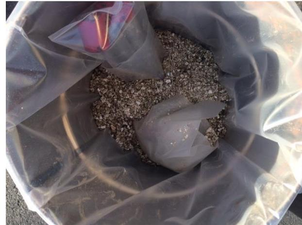
Beschädigter Akku in Kunststoffbeutel in Vermiculite
